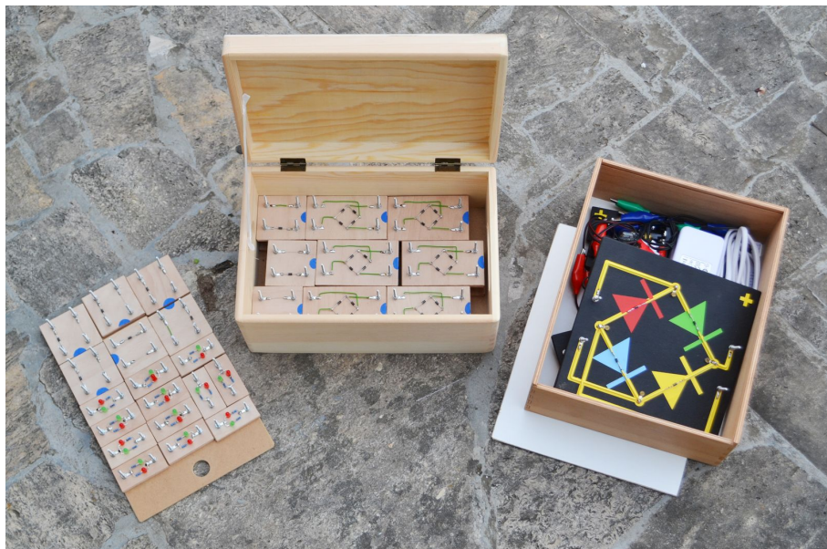
Obrázek 35: Sada pro výuku usměrnění střídavého proudu
